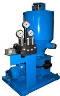
Станции смазки двухмагистральные ССД 0100-1, ССД 0160-1, ССД 0630-1, ССД 0100-2, ССД 0160-2, ССД 0630-2 используются для подачи пластичных смазок в резервуары смазочных станций систем смазки периодического действия при температуре окружающей среды от 10 до 40°C.
