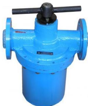
**Фильтр ФДЖ-50.00.00** предназначен для грубой очистки минеральных масел от механических примесей в циркуляционных системах смазки. Фильтр работает на минеральных маслах кинематической вязкости от 10 до 750 мм<sup>2</sup>/с. Диапазон окружающей среды 0...+40 °С. Температура масла +5...+80 °С.
