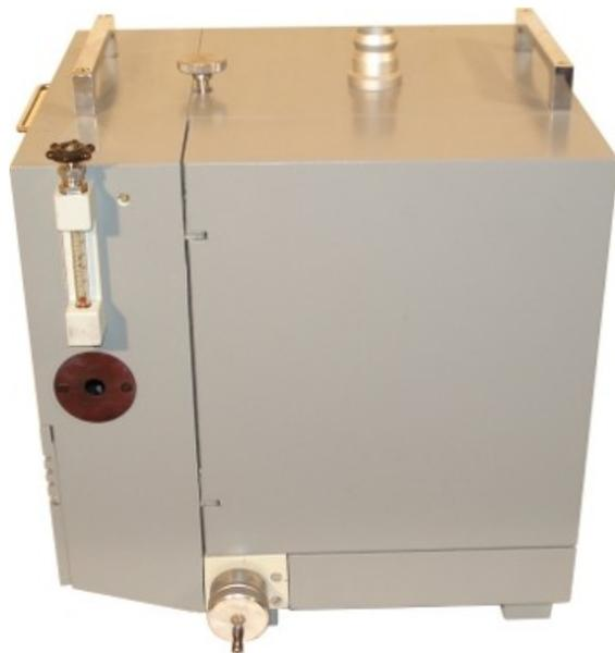
«ТИТАН СЛ» - специализированный спектрометр для определения концентрации водорода в титановых сплавах. Выполнен на базе стандартного штатива УШТ-4.
