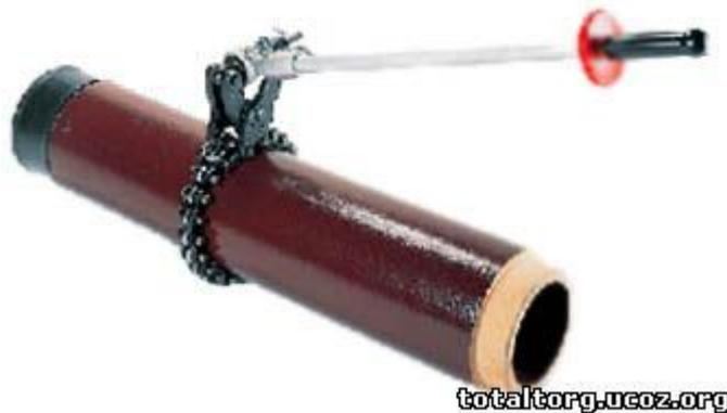
Режет 2"-6" чугунные, керамические и асбестоцементные трубы. Рукоятка выполнена в форме U для более удобной переноски. Идеален для использования в местах с недостатком рабочего пространства. Ручка легко устанавливается в четырех положениях наиболее удобных для пользователя. Быстроразъемный стяжной болт легко приводится в действие ключом-трещеткой или любым другим ключом.
