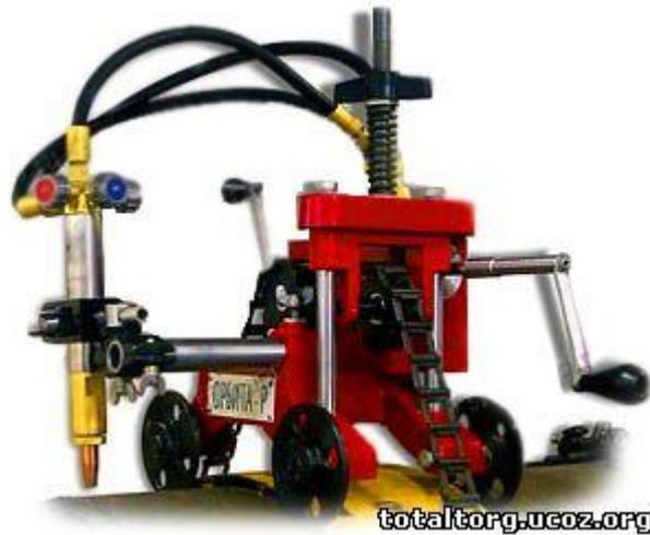
Машина переносная «Орбита» (Орбита ручная) предназначена для кислородной резки стальных труб в полевых условиях и условиях промышленных предприятий.
