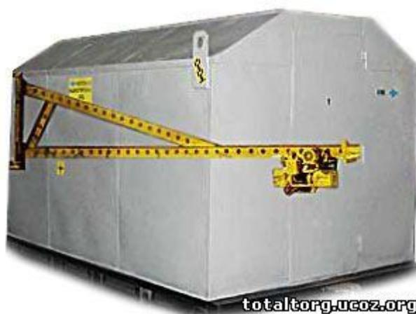
Контейнер **КПП321** применяется для подготовки, хранения и выдачи рулонных изоляционных материалов в период производства изоляционных работ при отрицательных температурах окружающего воздуха (до -40С). Контейнер обеспечивает постепенный прогрев на всю глубину одновременно 35 рулонов изоляционного материала до +60С. Для подачи рулонов к изоляционной машине контейнер может быть укомплектован дополнительно краном-укосиной.
