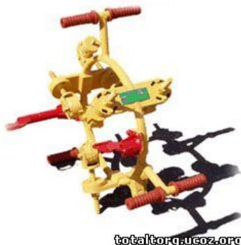
Приспособления имеют плоскость разреза для установки в любом месте трубопровода. Количество устанавливаемых шпуров – две. Тип изоляционного покрытия – нормальный, усиленный из липких полимерных лент по ГОСТ25812-83, усиленный из лент по ГОСТ9.602-89. Максимальный диаметр рулона – 260-270 мм. Привод приспособлений ручной.
