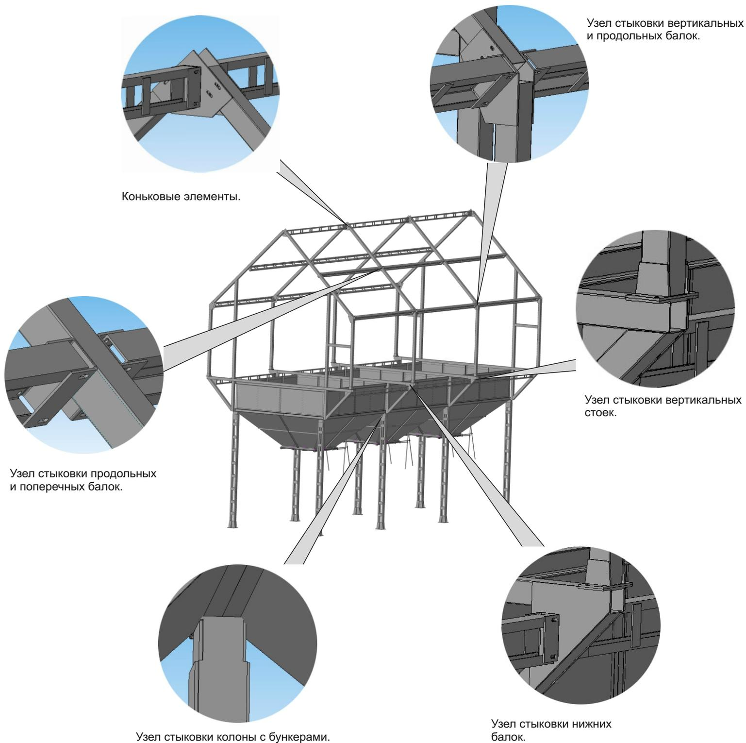
В состав комплекса входит: колонны, углы бункеров, шиберные задвижки, стенки бункеров, перегородка, каркас крыши, швеллера усиления.
